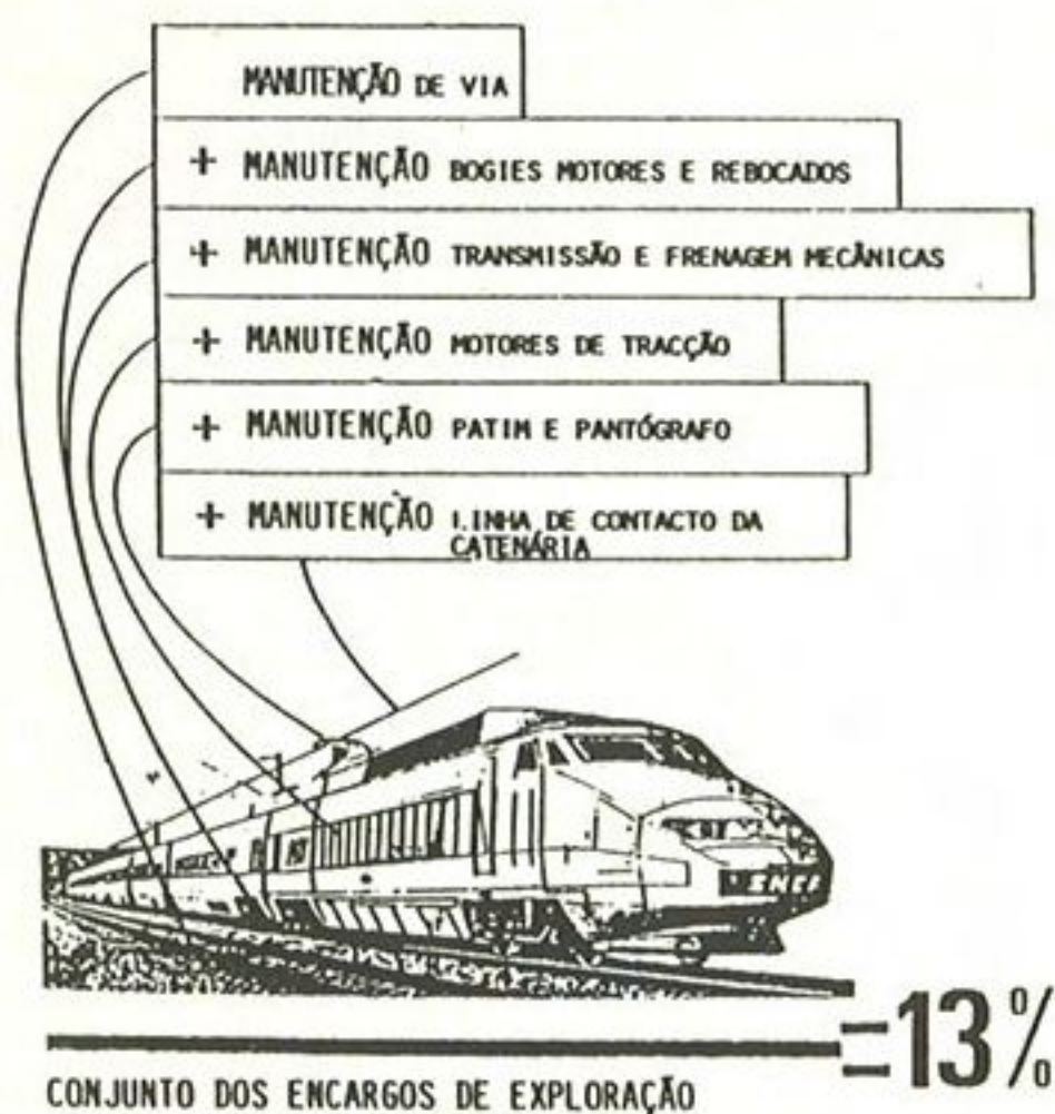
Fig. 7 — Rácio específico do sistema roda carril com TGV
