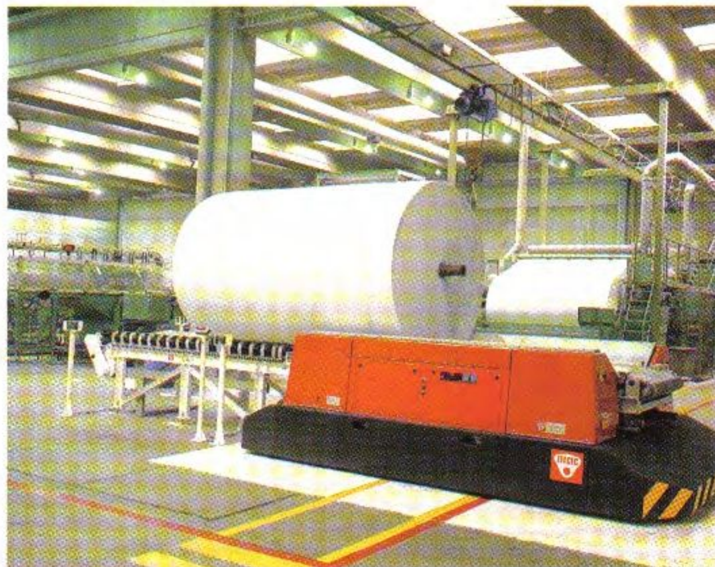
Movimentação de bobinas de papel de 3 t - Renova
