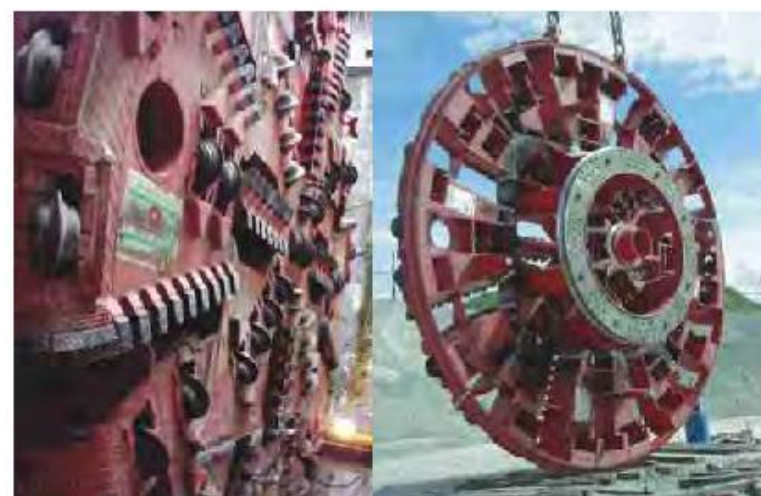
Montagem da Tuneladora
