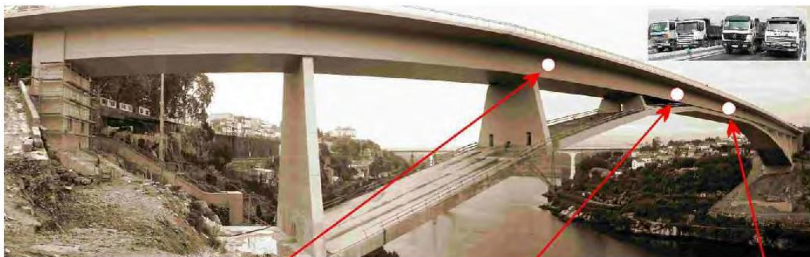
Prueba quasi-estática Extensómetros de sección S28c
